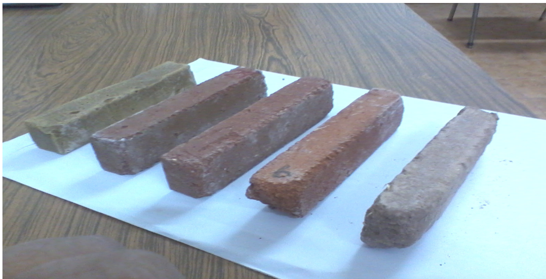
Figura 3. De derecha a izquierda: Probetas moldeadas: inicial y cocidas a temperaturas crecientes
